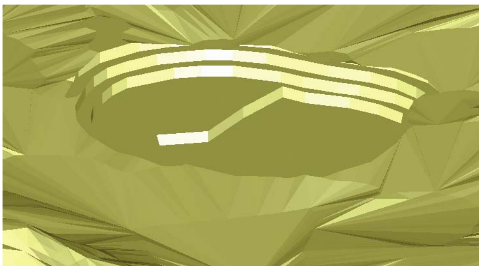
Figura 4a. EOP para el período P0812 del ejemplo 1 con elevaciones a partir del pie del banco del 3DBM.
